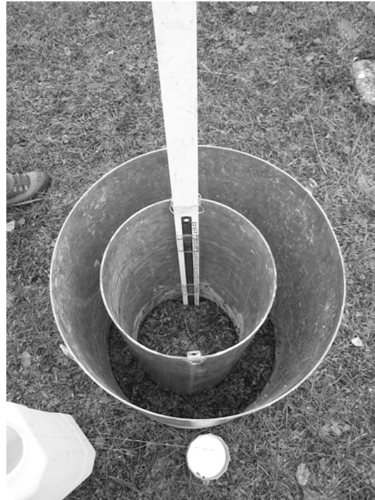
Figura 1. Infiltrómetro de doble anillo. Figure 1. Double ring infiltrometer.
