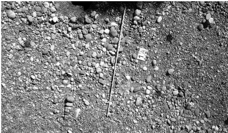
Figura 5. Imagen de la barra a escala 1:45 (método fotográfico remoto). Figure 5. Gravel bar at 1:45 scale (remote photography method).
