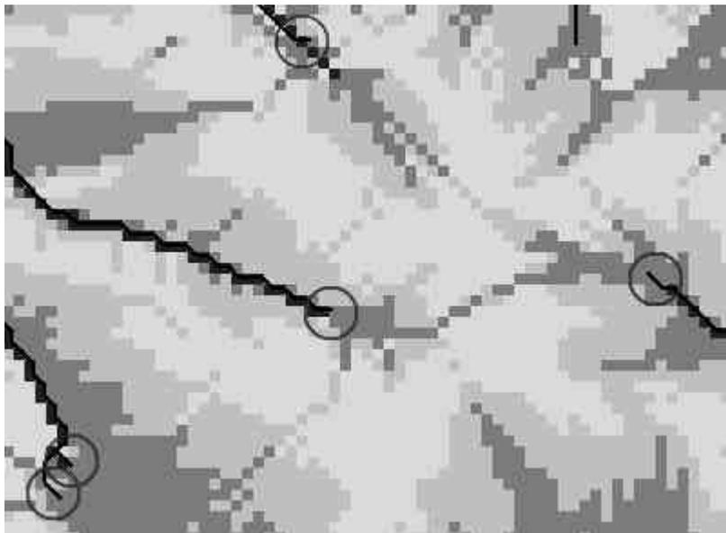
Figura 4. Extracto de la zona de estudio. El trazado en color negro señala la trayectoria de la red según el modelo D8 frente a la del modelo D $\infty$ , las celdas en azul oscuro que discurren próximas al anterior. Los círculos en color rojo destacan las celdas en las que no se produce la coincidencia que requiere una estricta comparación.
