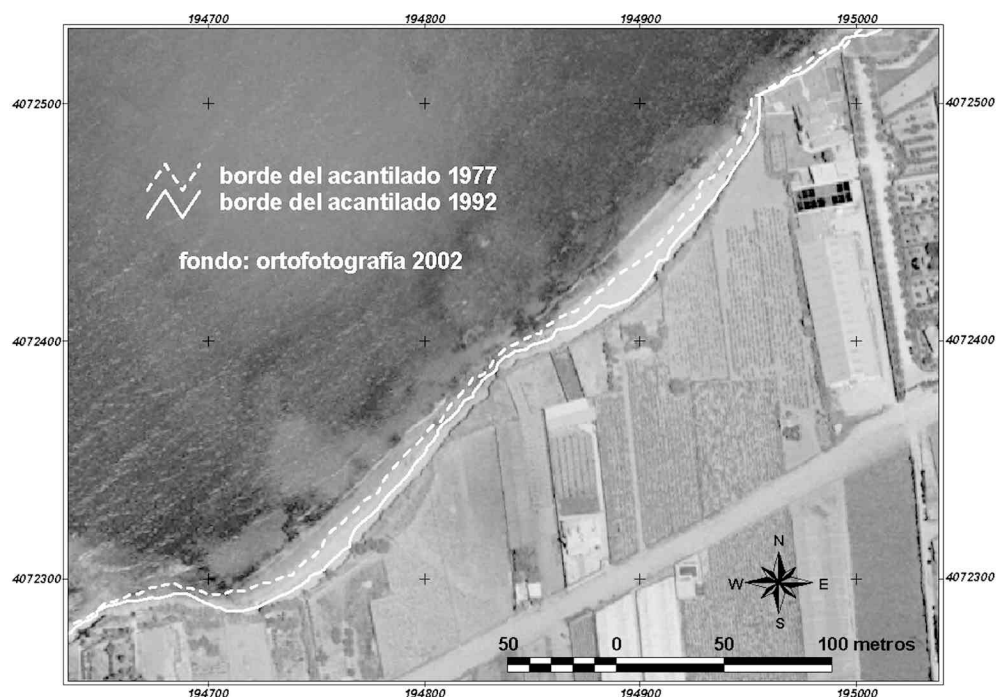
Figura 5. Evolución, a partir de fotografías aéreas, de un tramo acantilado en las cercanías de Punta Montijo. Nótese el progresivo retroceso de la línea de costa de 1977 a 1992 y 2002.
