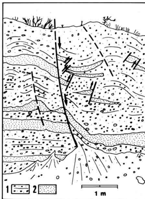
Figura 3. Fallas normales e inversas en la terraza de 150 m del río Noguera Ribagorzana al N de Alfarrás. 1: Gravas. 2: Arenas y limos.
