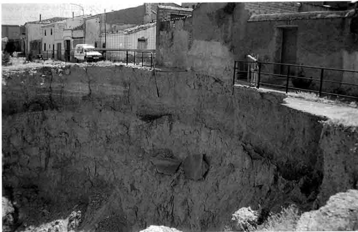
Figura 12. Cicatriz activa del deslizamiento correspondiente al punto A de la figura 8. Active scarp of the slope movement corresponding to point A in figure 8.
