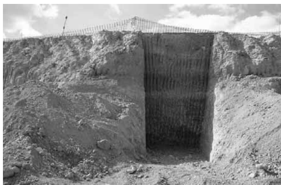
Fig. 3: Cata arqueológica usada para el análisis de los depósitos holocenos del bloque de techo de la falla.
