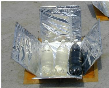
**Figura 1.** Concentrador solar para desinfección de agua
