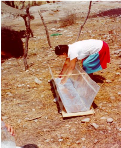
**Figura. 15.** Concentrador solar para desinfectar agua en 8 botellas.
